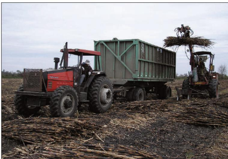
**Figura 23. Máquina cargadora depositando caña en un carro tipo Java**
